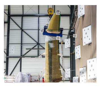
Die optischen Messschilder an der Hallenwand detektieren die Verformung in den drei Hauptachsen des Blattes. © Fraunhofer IWES, Pascal Hancz | Bild in Farbe und Druckqualität: www.fraunhofer.de/presse.
